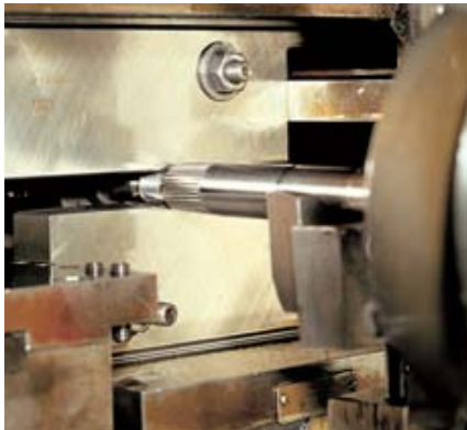
▲セレーションとねじを同時転造作業中 *Specifications and types of counter-flow rolling dies
